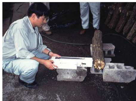
写真-2 草木演習林近くのシイタケ栽培農家のホダ木でレジストグラフの試験を実施する筆者
