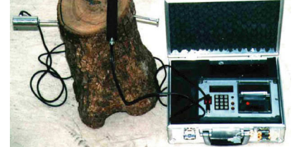
レジストグラフは材の硬さに応じてギアを入れ替えていた。
