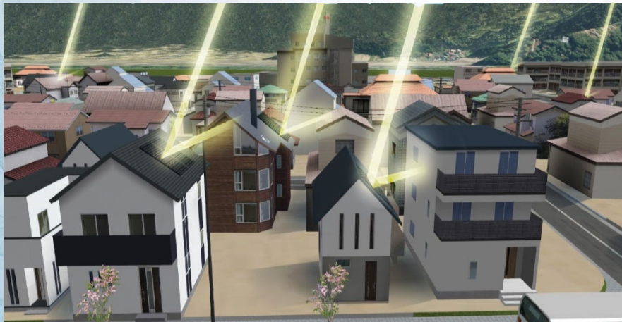
左：シミュレーションイメージ／右：太陽光パネル設置情報を読み込み、3D都市モデルの建物の屋根に太陽光パネルを自動描画
