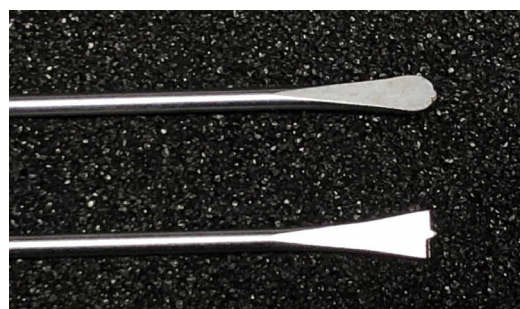
写真4 摩耗して刃が丸くなったキリ(上)
